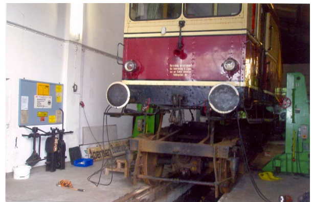
Der Triebwagen ist angehoben und das erste Drehgestell wird herausgezogen. (Fotos: P. Schütt)
