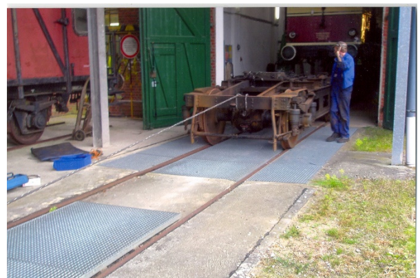
Der Triebwagen ist angehoben und das erste Drehgestell wird herausgezogen. (Fotos: P. Schütt)
